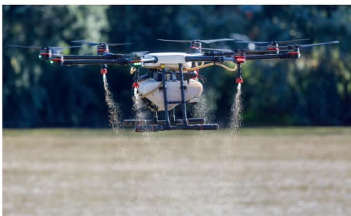
Figura 7. Tratamiento larvicida con Bti mediante el empleo de un drone (Fuente: Ayuntamiento de Zaragoza)
