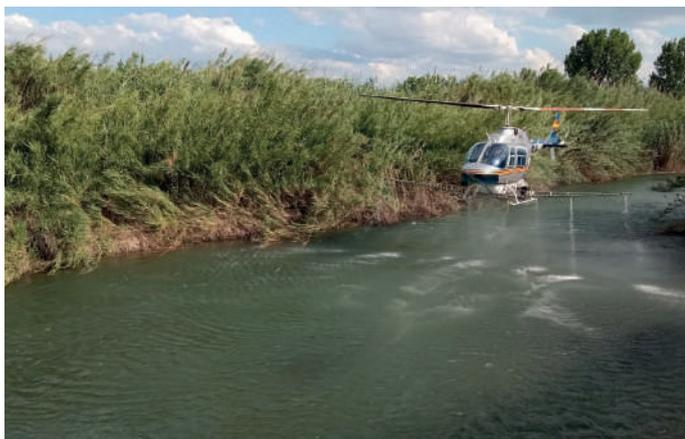
Figura 6. Aplicación aérea de Bti mediante helicóptero en un tramo fluvial inaccesible por medios terrestres (Fuente: Lokímica).
